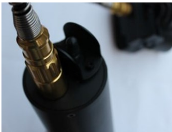
Figura 7: fissaggio del connettore sul Canister
