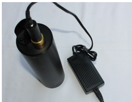
Figura 6: collegamento completo tra caricabatteria e Canister
