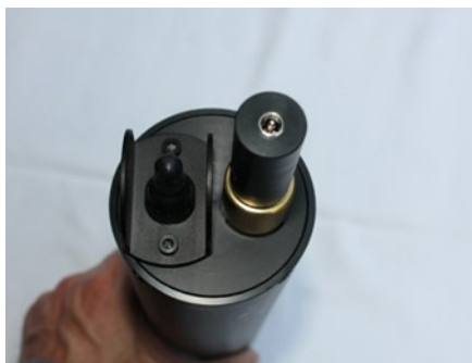
Figura 5: inserimento dell'adattatore nel connettore del Canister.
