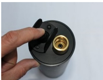
Figura 8: azionamento dell'interruttore a leva sul Canister
